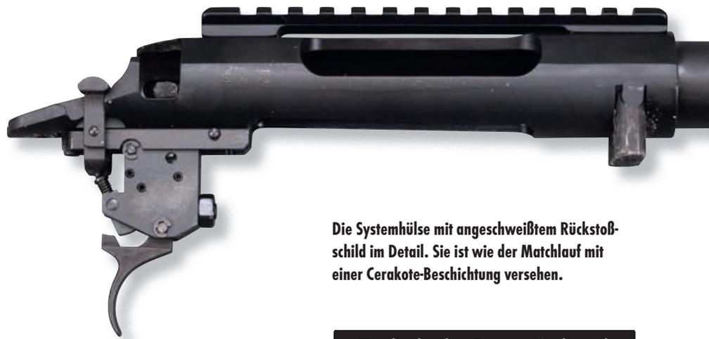
Die Systemhülse mit angeschweißtem Rückstoßschild im Detail. Sie ist wie der Matchlauf mit einer Cerakote-Beschichtung versehen.
